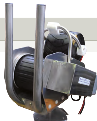
El-drevet garnspil. Idél til mindre både / Electrically driven nethauler. Ideal for smaller boats.
