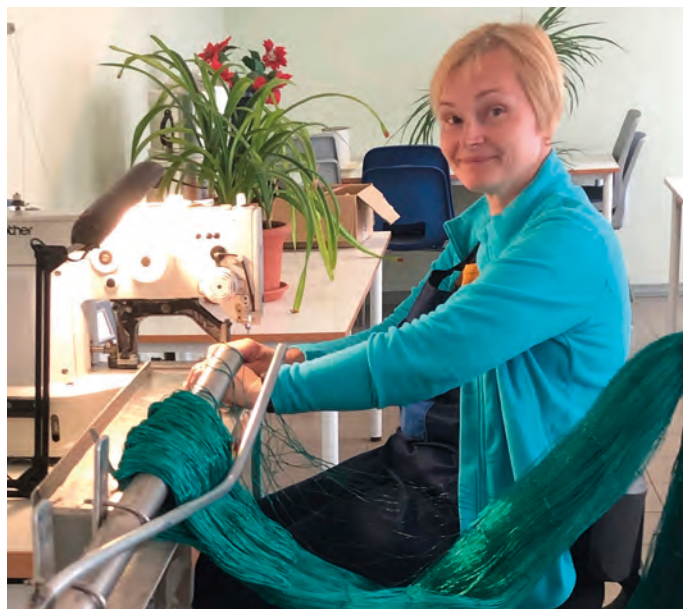
Genmontering på brugte liner op til Ø 25 mm og 3 str. reb op til Ø 14 mm. / Remounting of old topline up to Ø 25 mm and 3 str. ropes up to Ø 14 mm.
